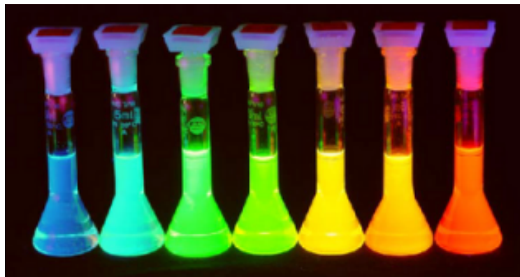
Slika 7: Fluorescenca, ki jo dobimo z UV osvetlitvijo CdSe kvantnih pik.
